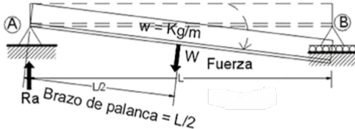
Figura 3.4: Momentos producido por la carga uniforme.
