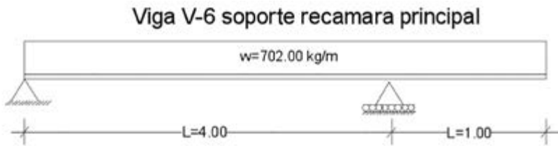
Figura 5.18: Cargas para diseño viga V-6.
