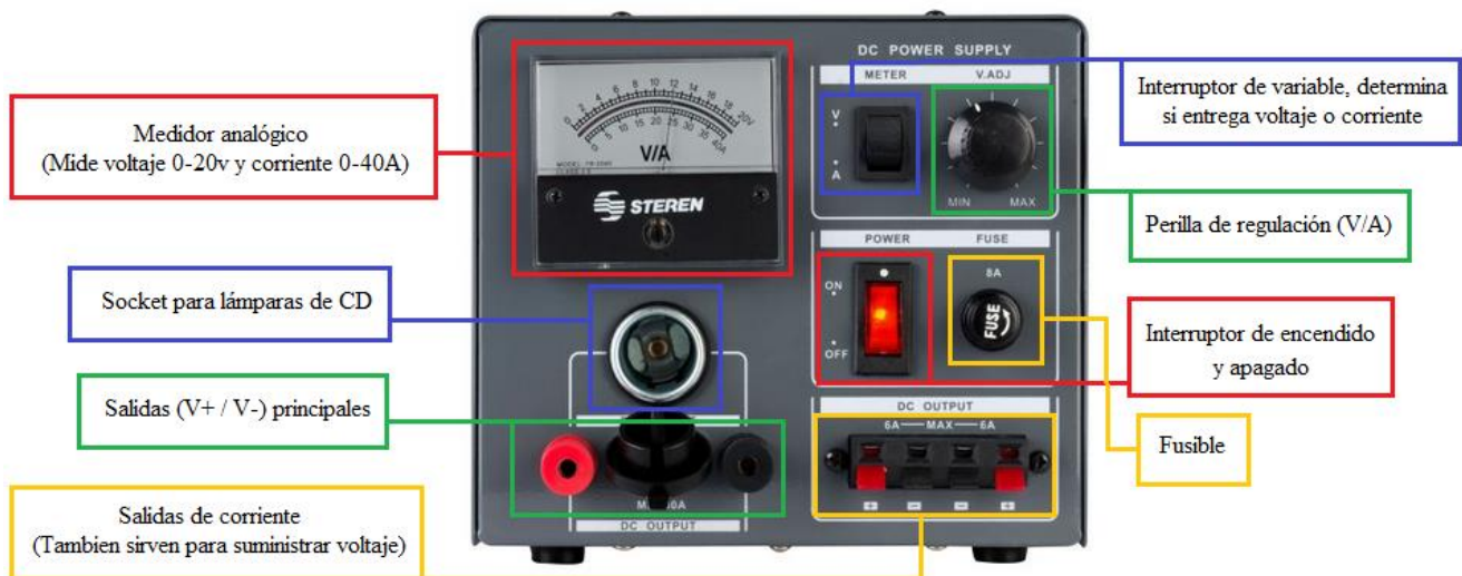
Figura 8. Componentes de la carátula de la fuente.
