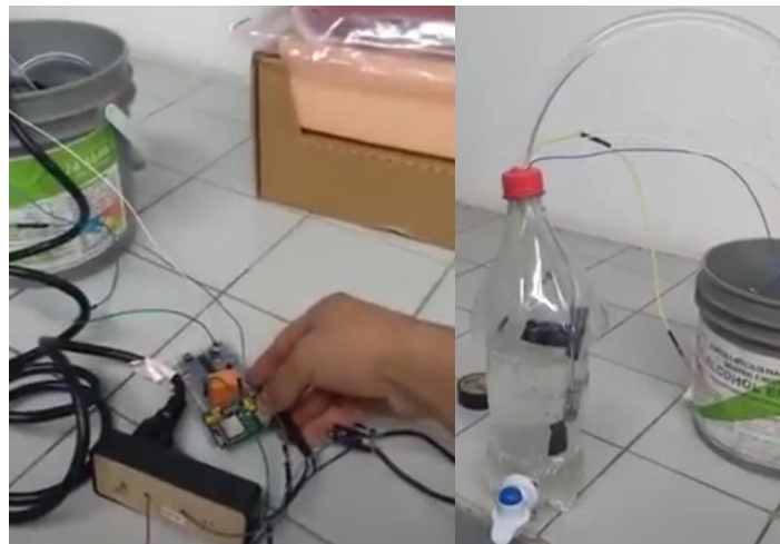
Figura 50 – Control de nivel de agua con PIC16F84A .
