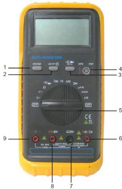
Figura 1. Controles del multímetro digital.
