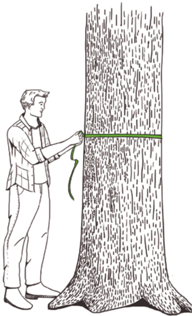
Figura 9: Medición del diámetro del árbol.
